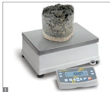
Balance industrielle à haute résolution également avec ajustage interne automatique et approbation d'homologation [M]
