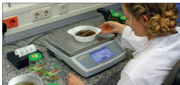
Contrôle d'échantillon d'un préemballage avec contenu vidé (analyse avec destruction d'échantillon)
