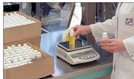
**Pesage avec plage de tolérance (Checkweighing)** : Un signal optique assiste la mise en portions, le dosage ou le triage
