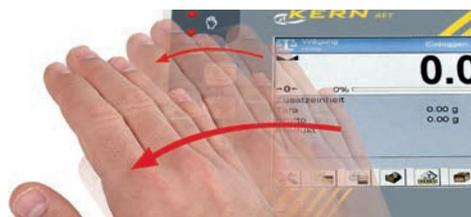
**2 capteurs à infrarouge** pour exécuter sans contact les fonctions comme la TARE, la mise à zéro, l'impression, le déclenchement ou l'annulation de l'ajustage, l'appel de la base de données ou du menu, etc. – un signe suffit !
