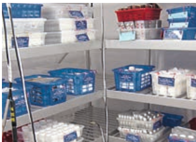
Essai de stabilité de médicaments selon les directives ICH dans la chambre climatique.
