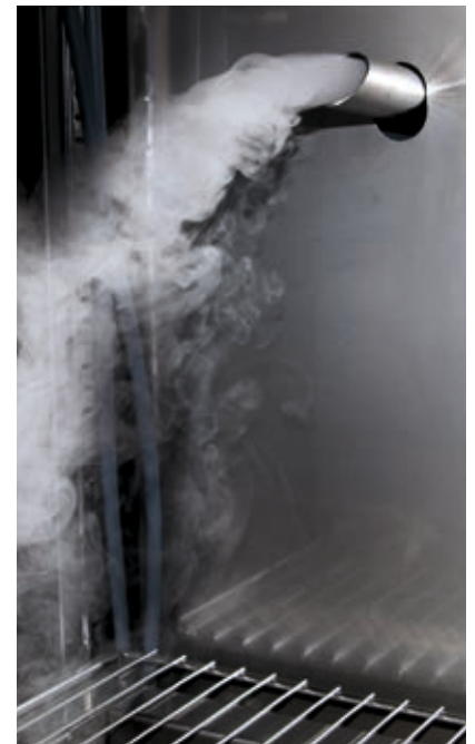
Brouillard d'aérosol sans admission de chaleur dans la chambre d'essais
